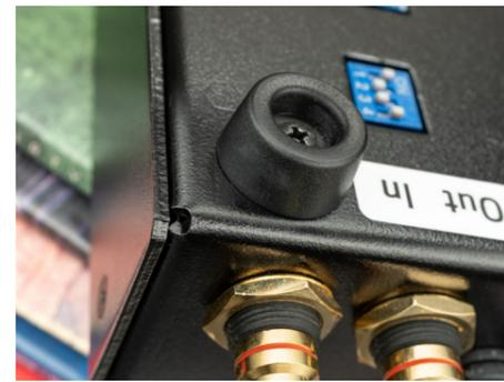
Die mittelharten Gummifüße absorbieren bis zu einem gewissen Grad klangschädliche Vibrationen, die entweder vom Gerät selbst erzeugt werden oder über den Untergrund hereingetragen werden.
