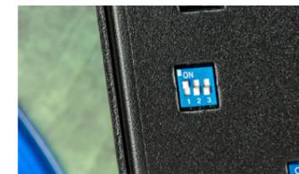
So sorgt der Black Cube SE II für mehr Pegel: Einfach nur bei den dreischaltigen Mäuseklavieren die bereits auf „ON“ gesetzte Nummer 1 aktiv lassen.
