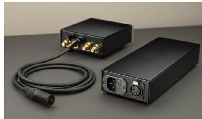
Auf der Rückseite der Stromversorgung sitzen der Anschluss für den Netzstecker und die vierpolige XLR-Buchse, in die das lange und isolierte Kabel des Audioteils eingesteckt wird. Durch diese Trennung von Verstärker und Stromversorgen können die beiden Komponenten weit voneinander entfernt positioniert werden.
