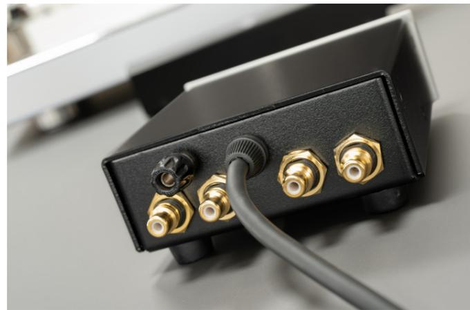
Das Audio-Teil ist mit ausgezeichneten Buchsen bestückt, die kanalweise angeordnet sind: Links sitzen die Ein- und Ausgänge des linken Stereo-Kanals, rechts finden wir die Ein- und Ausgänge des rechten Stereo-Kanals.
