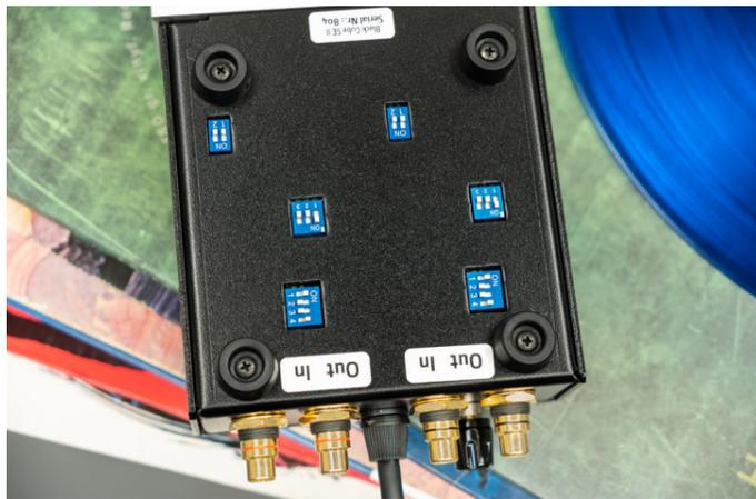
Auf der Unterseite des Audioteils sind drei blaue Mäuseklaviere eingelassen. Mit diesen DIP-Schaltern stellt man die passenden Werte für MM- oder MC-Plattenspieler ein, aber auch den Bassfilter und die Gain-Anhebung.
