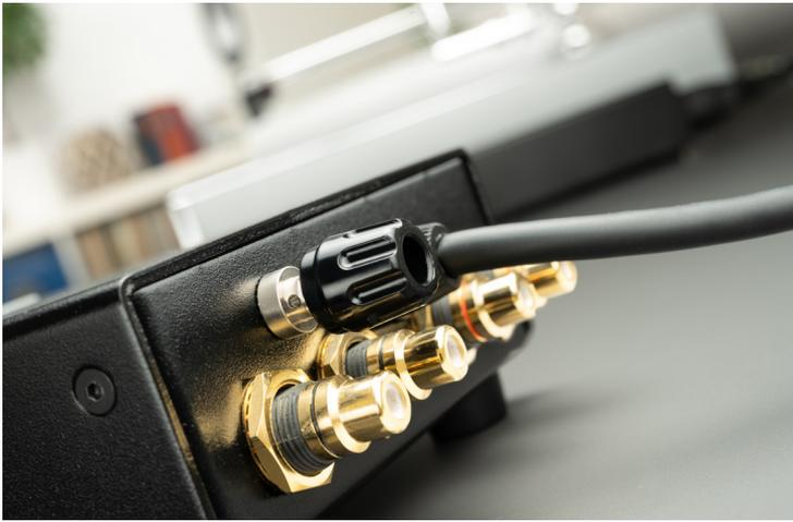
Der Black Cube SE II uíst mit einer Erdungsklemme ausgestattet. Hier wird die Erdungsleitung des Plattenspieler-Kabels angeschlossen. Durch diese Maßnahme beseitigt man das Brummgeräusch, das sonst oft beim Plattenspielerbetrieb zu hören ist.
